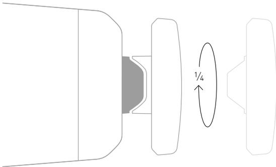
Durch eine Vierteldrehung ist jeder Aufsatz ohne Kraftaufwand oder Geschick in den Händen leicht anzubringen oder zu lösen.
